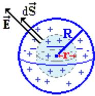
La superficie gaussiana que se toma es una esfera concéntrica interior de radio  $r$  que pase por el punto donde se desea calcular el campo eléctrico.
