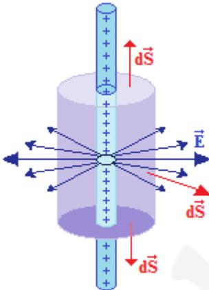
Las líneas del campo salen en forma radial del hilo. La superficie gaussiana es un cilindro de radio  $r$  y de longitud  $L$ .
