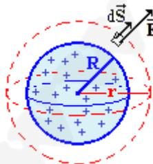
Para calcular el campo en un punto  $P$  exterior a la esfera y a una distancia  $r$ , elegimos como superficie gaussiana una esfera de radio  $r$  que pase por  $P$ .
