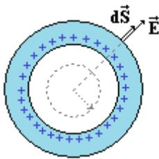
En el interior de una esfera metálica hueca, al repelerse las cargas, se sitúan en la superficie interior del metal. Si elegimos una superficie gaussiana en el interior, no habrá carga encerrada y el flujo será nulo ( $\Phi = 0$ ) por tanto el campo eléctrico es nulo.
