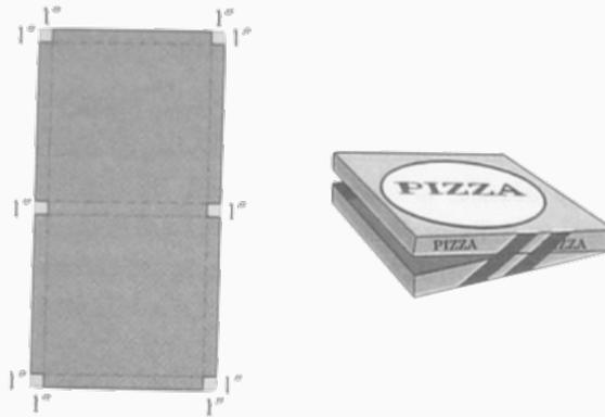
**Figura 7.4:** Construcción de una caja para pizza.
