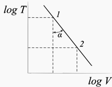
**Figura 9.3:** Gráfica en escala log – log de la velocidad de corte contra la vida de la herramienta.
