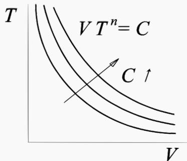
**Figura 9.2:** Gráfica de la velocidad de corte contra la vida de la herramienta.
