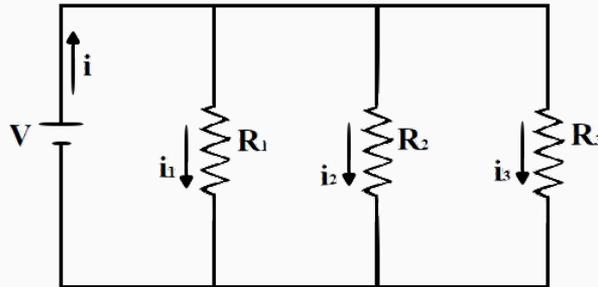
Figura 7.3: Resistencias  $R_1$ ,  $R_2$  y  $R_3$  en Paralelo
